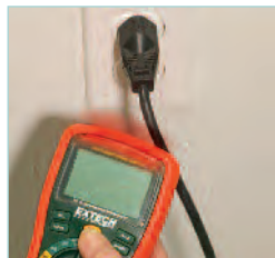
Detector de voltaje sin contacto integrado — Para comprobar rápidamente la presencia de cables en vivo antes de la prueba.
