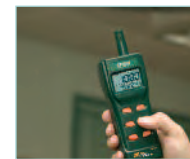
Medición del nivel de CO 2 en edificios de oficinas para verificar la calidad del aire de salas de conferencia asegurando una ventilación apropiada.
