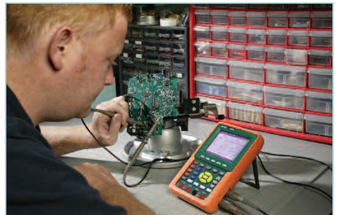
Pruebas doble rastro o solución de problemas en tarjetas de circuito y ensambles electrónicos
